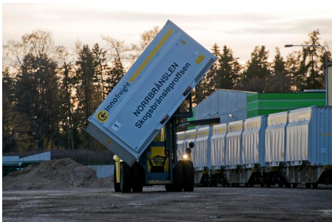
Figur 5 Tömning av container från tåg
