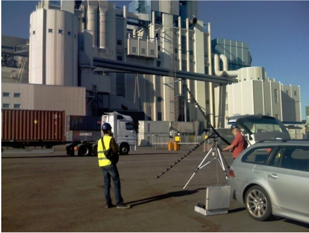
Figur 12 Bullermätning med akustisk kamera
