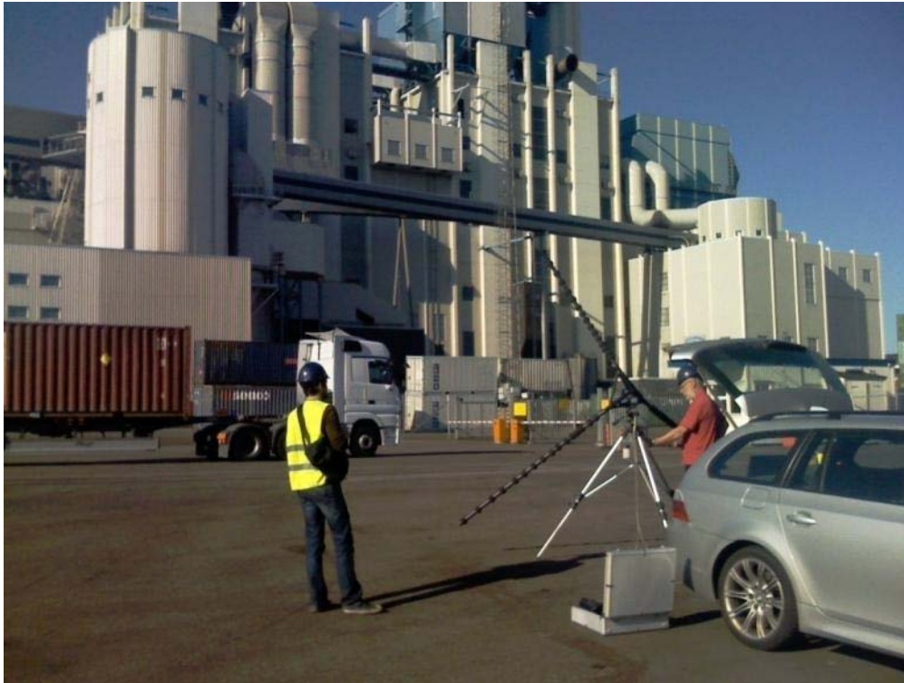
Figur 10 Bullermätning med akustisk kamera
