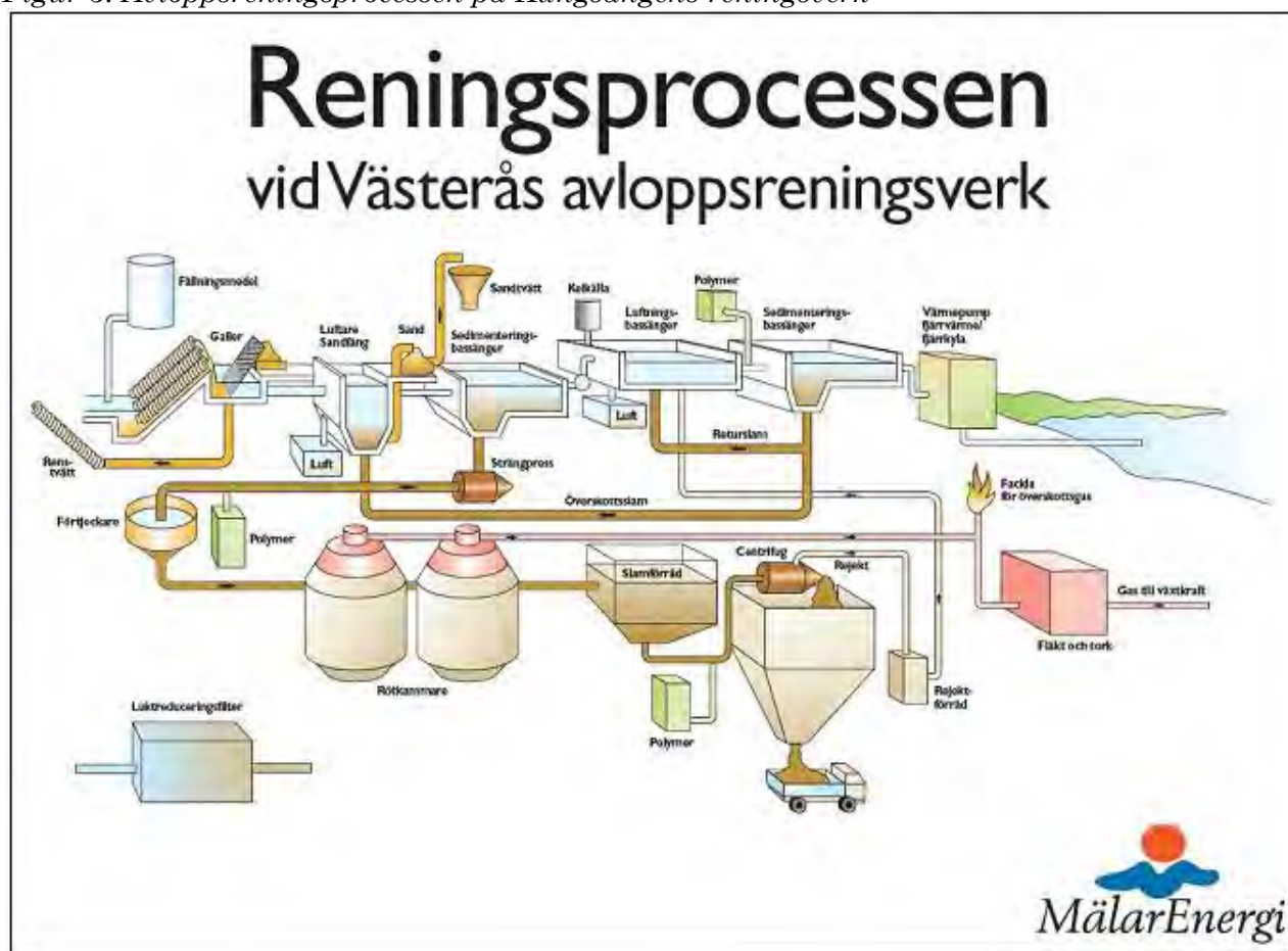
Figur 3. Avloppsreningsprocessen på Kungsängens reningsverk
