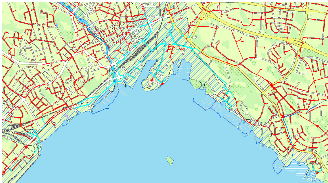
Figur 5: Spillvattenledningar belägna under nivån +1,20 i RH 2000 visas i turkos/blå färg. I kartan framgår även i vilka områden det troligtvis finns ett vattenförande friktionslager under leran. (Underlagskarta LMF, Västerås stad.)
