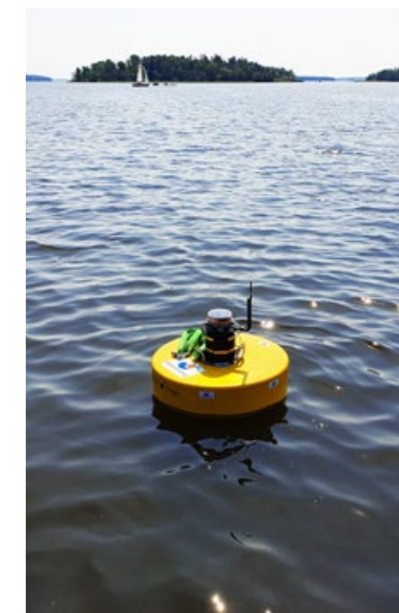
En sensorboj som mäter och larmar vid utsläpp.
