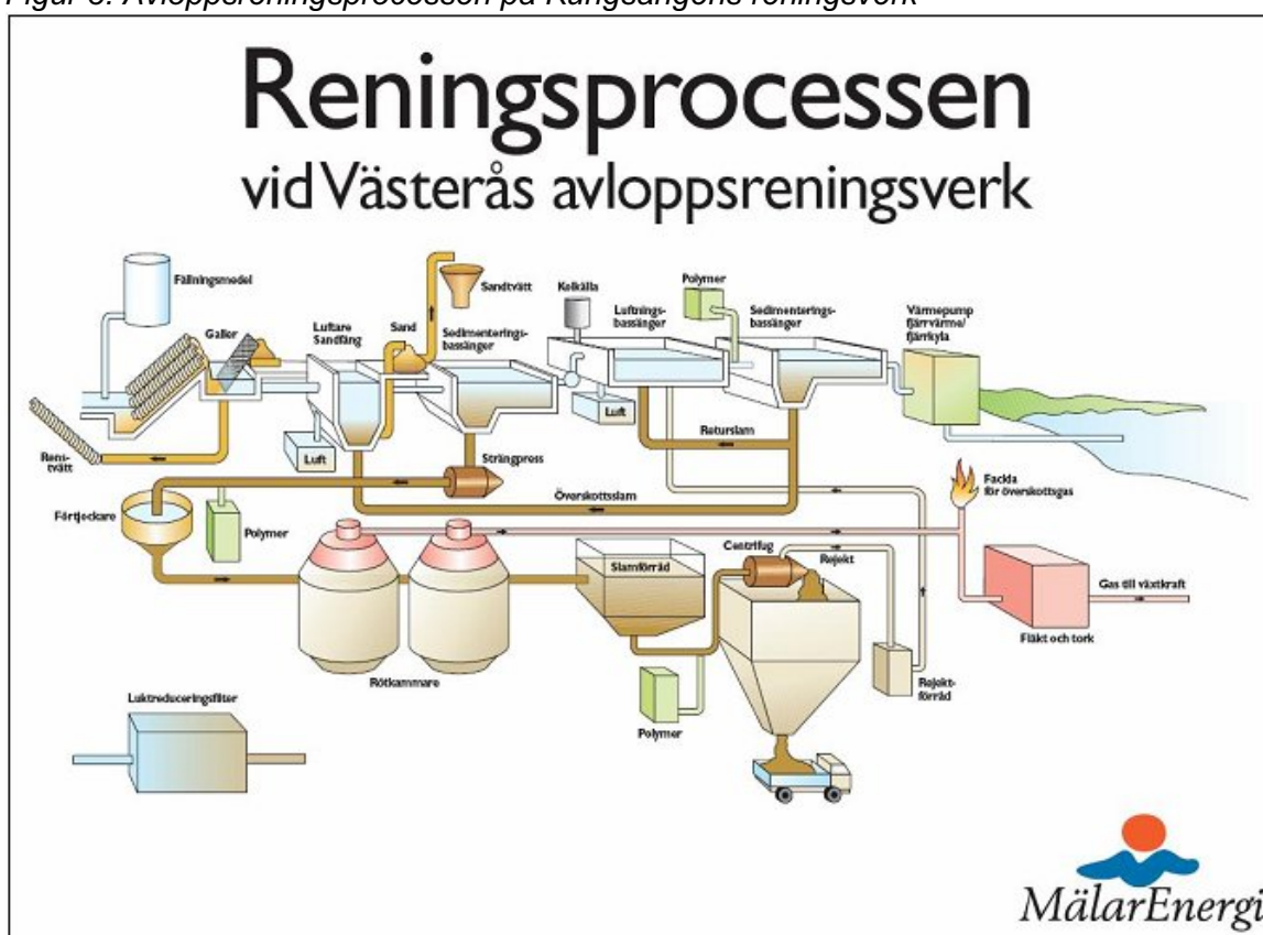
Figur 3. Avloppsreningsprocessen på Kungsängens reningsverk
