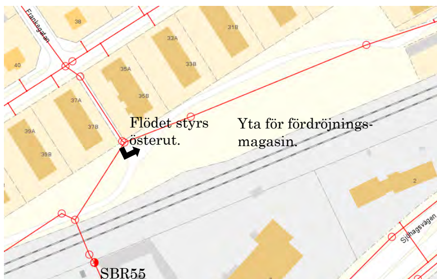
Figur 4: Bräddavloppet SBR55 och yta för planerat fördröjningsmagasin.
