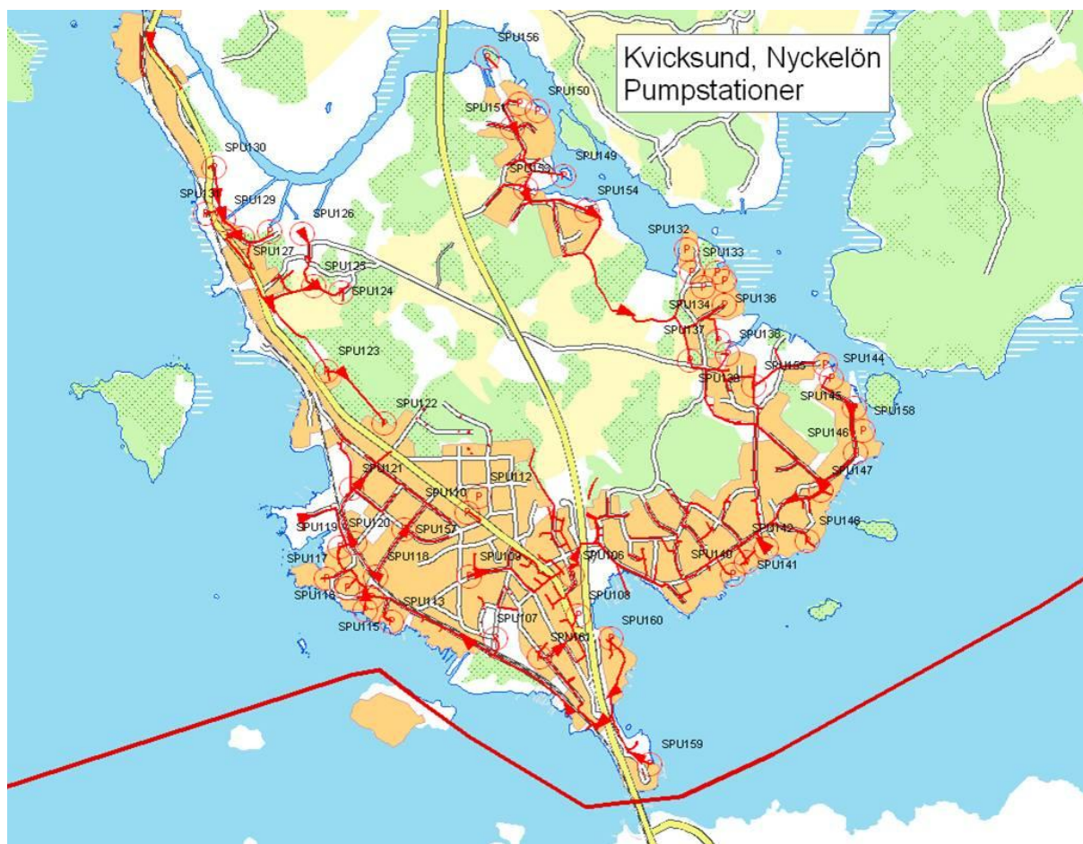
Figur 2. Spillvattennätet på Nyckelön med pumpstationer.
