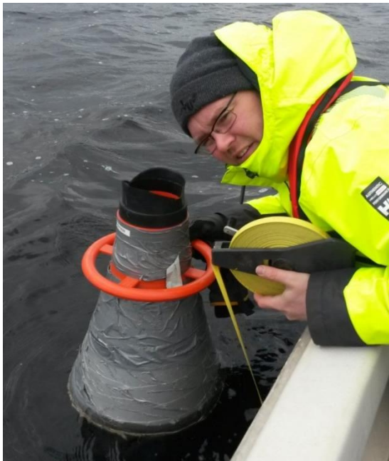
Figur 24. Mätning av siktdjup med vattenkikare och siktskiva. Foto: SGS.
