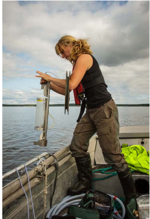
Figur 25. Provtagning med Ruttnerhämtare. Foto: ALcontrol.
