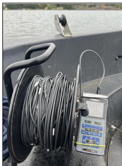
Foto 1. Mätning av syrehalt och temperatur. Foto:SGS.
