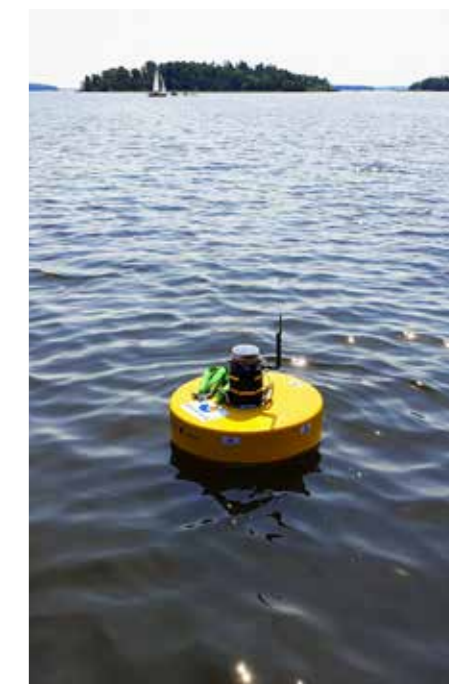
En sensorboj som mäter och larmar vid utsläpp.
