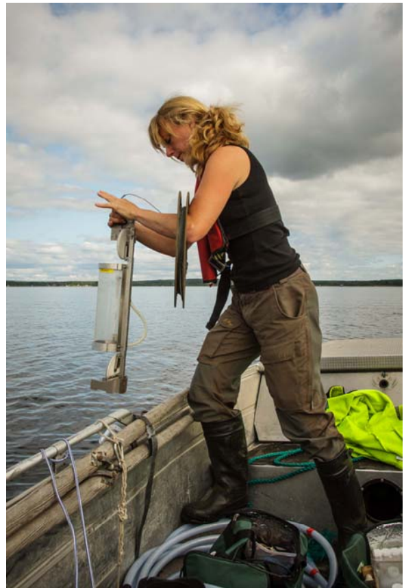
Figur 25. Provtagning med Ruttnerhämtare. Foto: ALcontrol.
