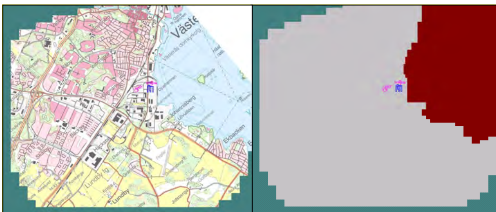
Figur 6. Till vänster en översikt över området och till höger illustreras var randvillkoren drän (grått fält) och konstanttrycknivå (rött fält) satts i modellens översta lager. Turkosa fält innebär att cellerna är inaktiva.
