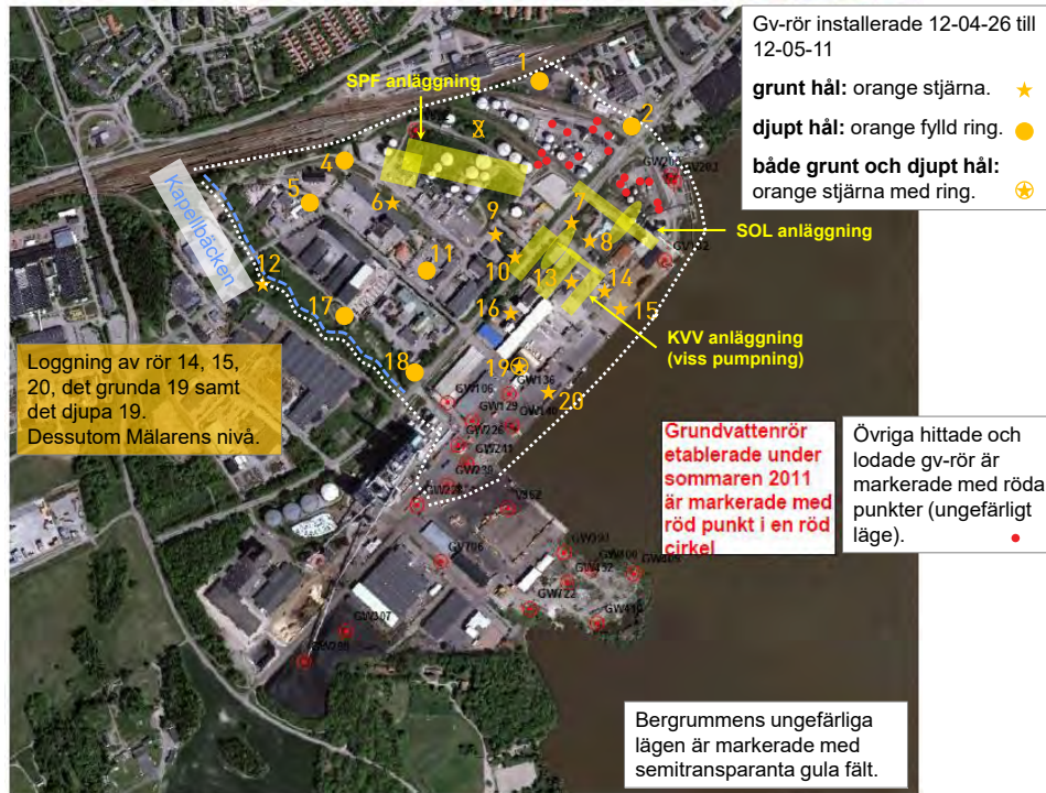
Figur 5: Nyinstallerade grundvattenrör i Västerås Hamn, ungefärliga lägen.
