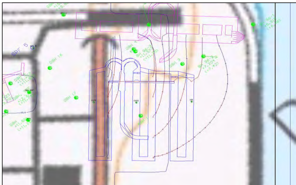
Figur 9 Plan som visar transporten av partiklar från Mälarenergis bergrum till OKQ8:s bergrum vid konstant trycknivå i OKQ8:s bergrum.
