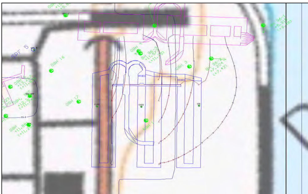
Figur 10. Plan som visar transporten av partiklar från Mälarenergis bergtrum till OKQ8:s bergtrum vid konstant trycknivå i OKQ8:s bergtrum.
