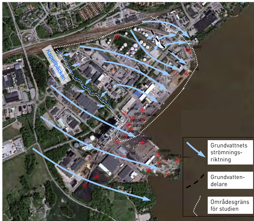
Figur 3: Konceptuell modell av den ostörda grundvattensituationen. Grundvattenströmningen är generellt riktad mot sydost med Mälaren som recipient. Berg i dagen i norra delen utgör en vattendelare. Kapellbäcken betraktas som ett utströmningsområde. Variationer p.g.a. jordlagrens inbördes position och mäktighet och bergytans läge ger upphov till detaljerade strömningsmönster som inte är analyserade.
