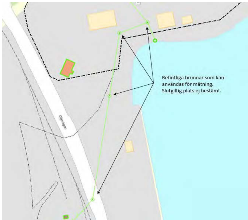
Figur 15: Befintliga dagvattenbrunnar nära utloppet till Mälaren som kan användas för mätning. Slutgiltig plats ej bestämt.
