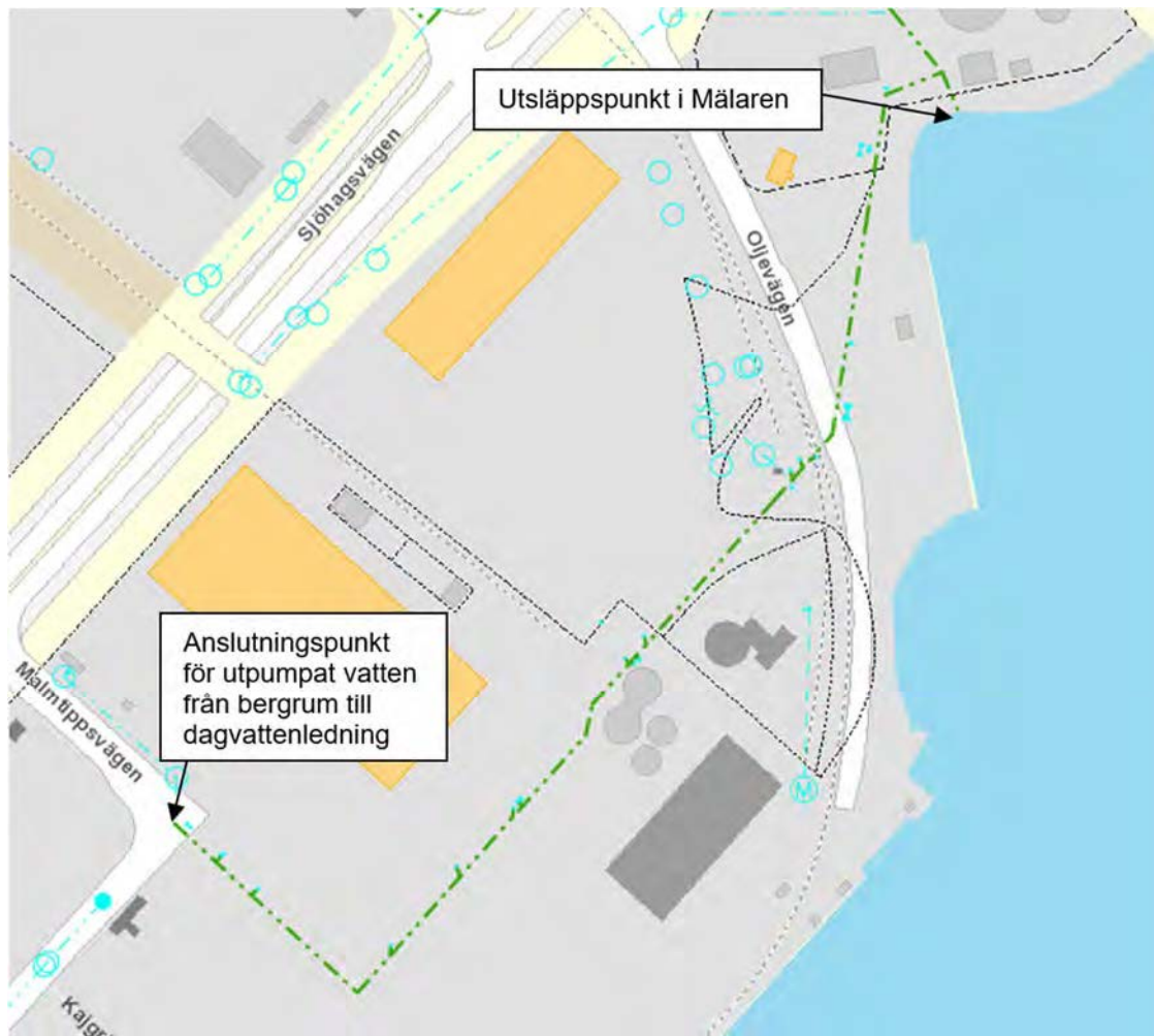
Figur 14. Avledning av utpumpat vatten (efter passage genom oljeavskiljare) via Mälarenergis dagvattenledning till Mälaren. Dagvattenledning ses med grön streckad linje.
