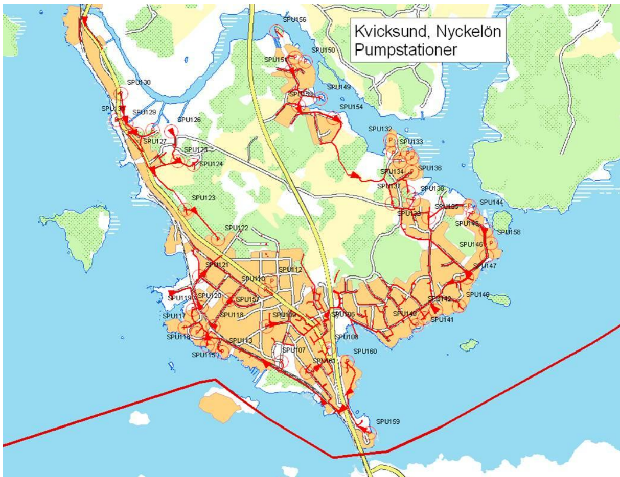
Figur 2. Spillvattennätet på Nyckelön med pumpstationer.
