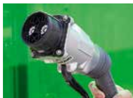
Chademo-kontakt. Laddning tar cirka 20 minuter.
